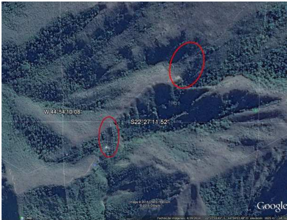
Figura 13: Os círculos vermelhos englobam pontos erosivos no trajeto percorrido. Pontos brancos são áreas de acumulação de sedimento.
